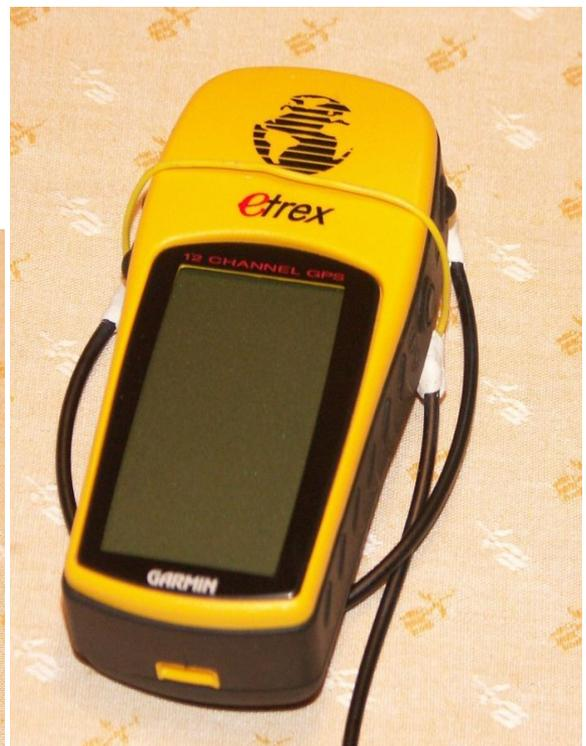
Die Empfangsergebnisse sind ebensogut wie bei der oben beschriebenen kapazitiven Ankoppelung. Die letztere Lösung ist natürlich einfacher und praktischer. Das Kabel wird noch etwas am eTraxgehäuse fixiert.
