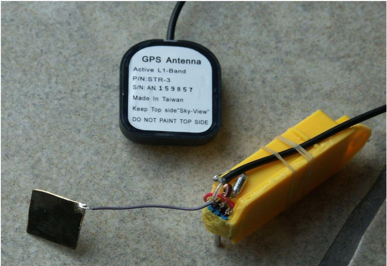
Die Empfangsergebnisse sind gut. Die Aktive Antenne hat ein Rauschzahl von 2dB. Die Pegelanzeige für die einzelnen Satelliten ist so, wie ohne die externe Antenne, tendenziell etwas besser. Mit Antenne auf dem Autodach viel höhere Pegel und mehr Satelliten im Vergleich zum bloßen eTrax hinter der Windschutzscheibe.
